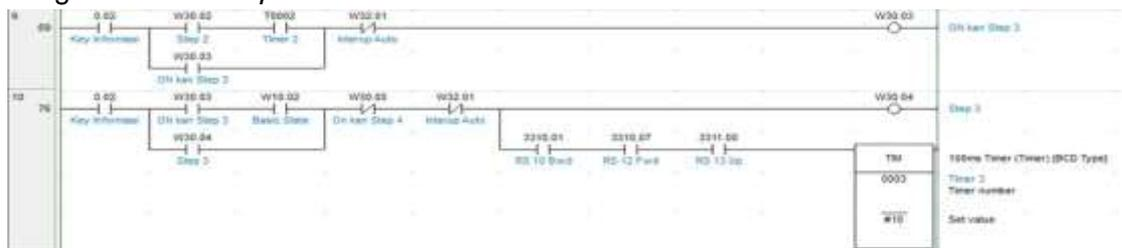
Gambar 5, Ladder diagram untuk step 3
