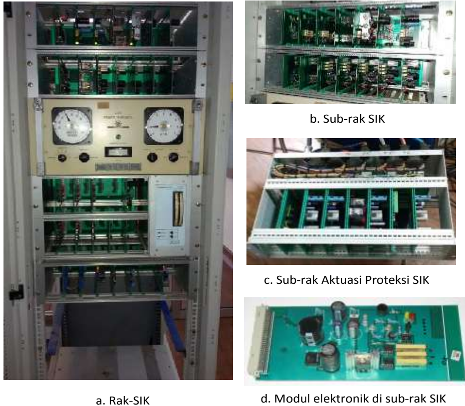
Gambar 2. Sistem Instrumentasi Kendali (SIK) [11] .
