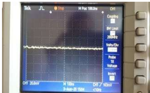
b. Catu-daya linier: Ripple dengan beban.
