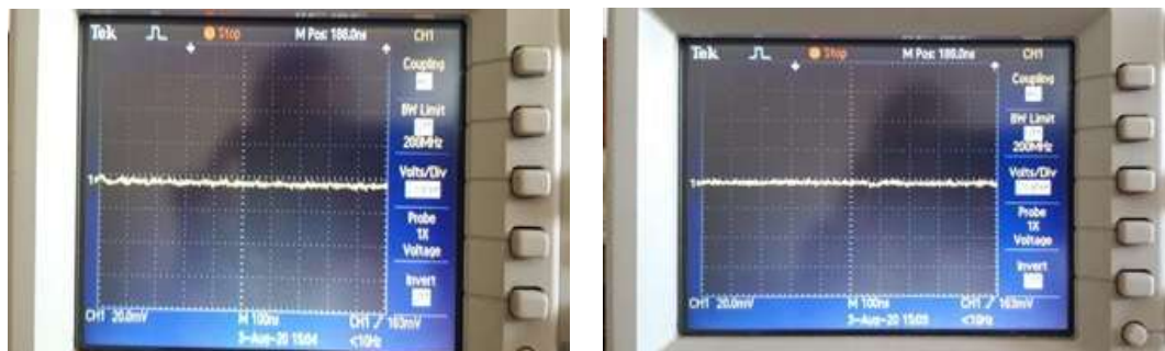
b. Catu-daya linier: Ripple dengan beban.
