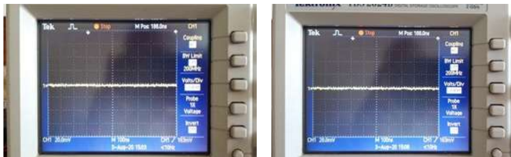
a. Catu-daya linier: Ripple tanpa beban.
