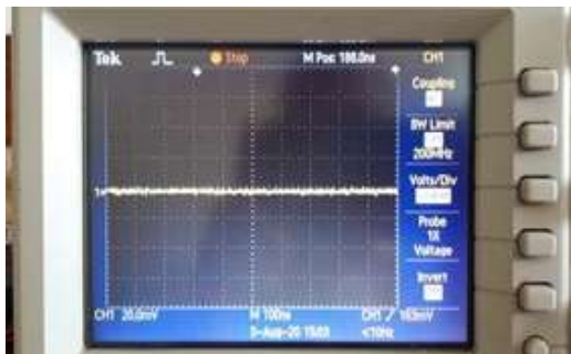
a. Catu-daya linier: Ripple tanpa beban.
