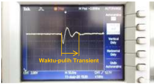
a. Catu-daya linier: Transient beban-ON.
