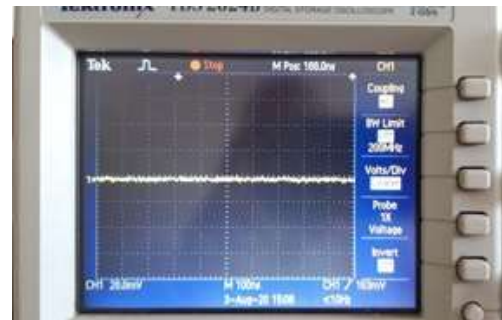
c. Catu-SMPS: Ripple tanpa beban.
