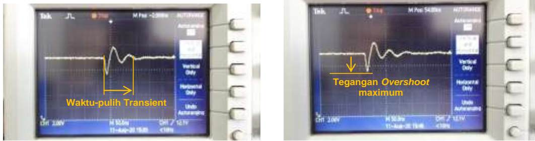
a. Catu-daya linier: Transient beban-ON.
