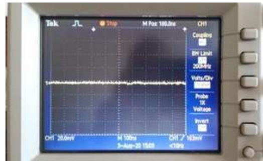
d. Catu-daya SMPS: Ripple dengan beban
