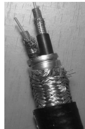
Gambar 7. Struktur kabel penghubung detektor menuju pre-Amp.
