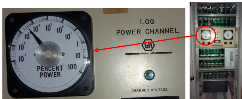
Gambar 3. Kondisi setelah START NLW2 menunjukkan angka diantara 10^{-5} dan 10^{-4} .
