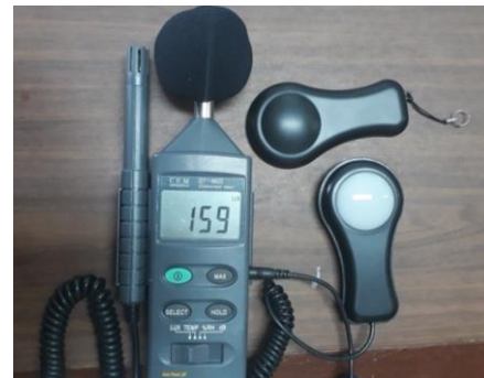
Gambar 7. Luxmeter yang dipergunakan untuk pengukuran intensitas cahaya.
