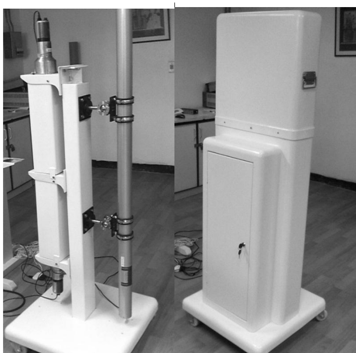
Gambar 8. Foto Tiang Statif Dan Sistem Casing .
