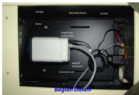
Gambar 8. Bagian dalam kotak penangkap citra sinar-X berbasis layar pendar
