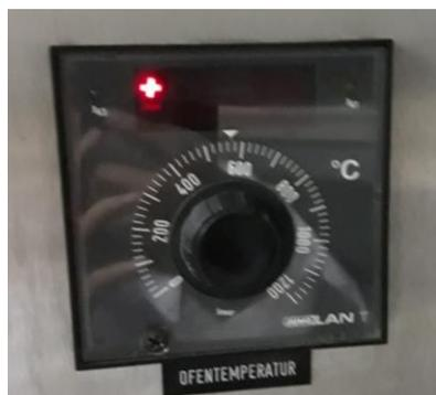
Gambar 5. Kontrol suhu alat TGA
