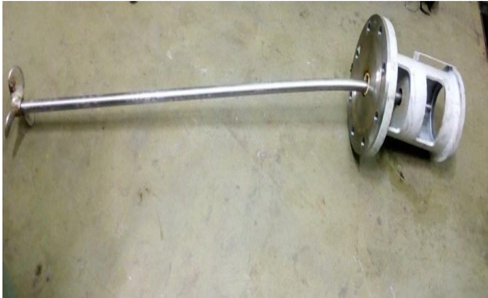
Gambar 4. Gambar pengaduk Tangki V-206 yang telah bengkok
