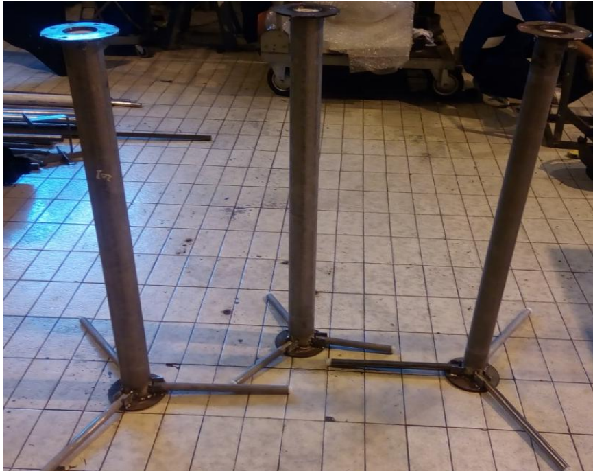
Gambar 5. Gambar pipa pelapis dan pipa penahan yang dipasang pada batang pengaduk
