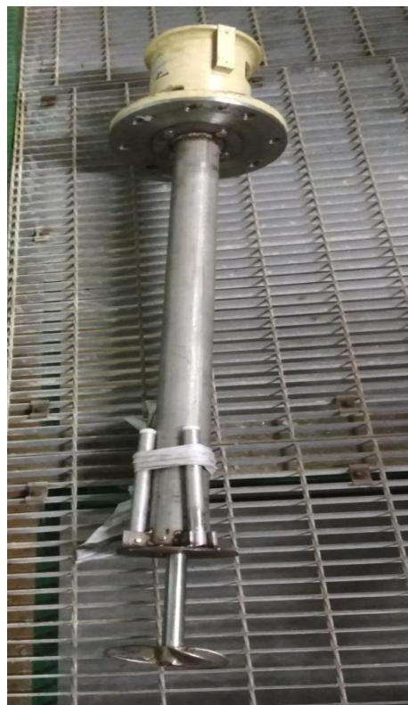
Gambar 6. Gambar pengaduk yang telah dimodifikasi
