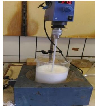
Gambar 3. Proses pengendapan ZOC
