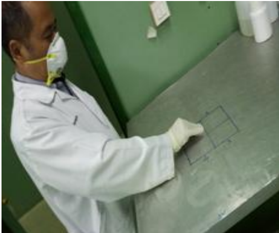
Gambar 1. Pengambilan sampel usap pada bahan permukaan baja tahan karat
