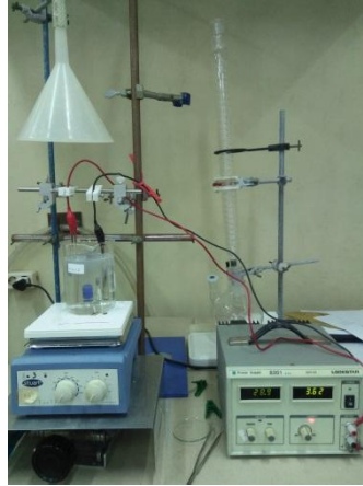
Gambar 3. Rangkaian peralatan Elektrolisis
