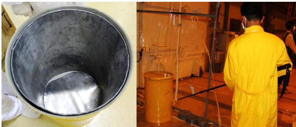
Gambar 3: Drum / wadah limbah radiasi tinggi yang bagian dalamnya dilapisi perisai radiasi Pb (kiri) dan pengukuran laju paparan radiasi pada permukaan kemasan drum / wadah limbah (kanan).
