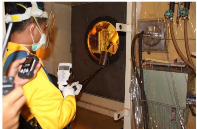
Gbr 2. Pengukuran Radioaktif menggunakan survey meter tongkat panjang
