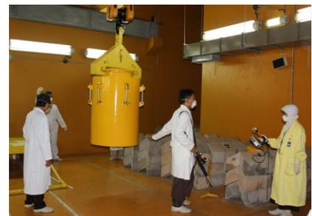
Gbr 7. Shielding limbah terbuat dari beton di R 013 IRM
