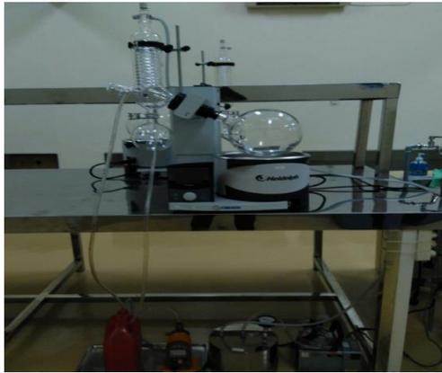
**Gambar 5.** Alat untuk Perendaman, Pucian dan Pemanasan dengan Evaporator
