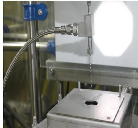
**Gambar 6.** Alat Penetes pada Proses Gelasi
