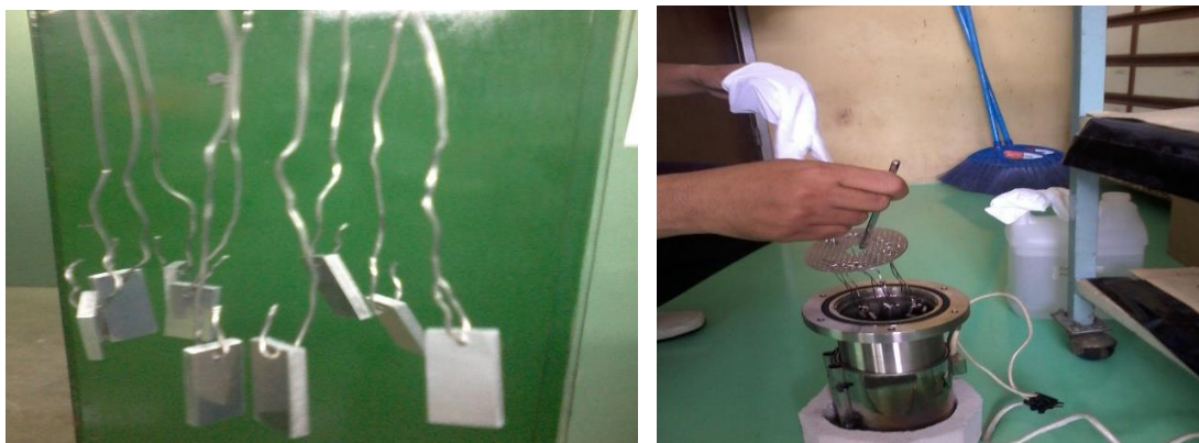
Gambar 3. Posisi percobaan uji pelat AlMg2
