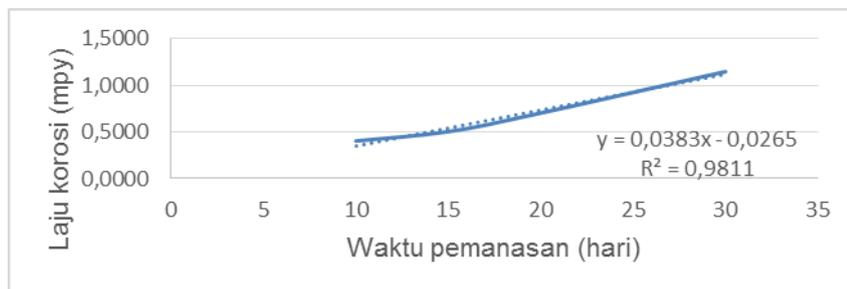
Gambar 5. Grafik 2 Hubungan waktu pemanasan dan laju korosi AlMg2 rol pada suhu 100°C
