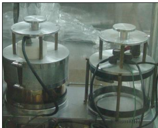
Gambar 10: Contoh sputter coating di dalam kotak berperisai radiasi [9]
