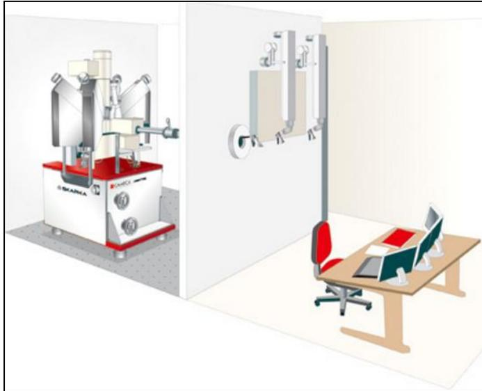
Gambar 1. EPMA di dalam kotak perisai radiasi dengan unit pengendali di luar<sup>[1]</sup>.
