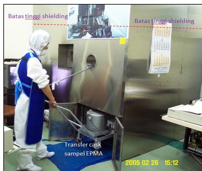
Gambar 6: Contoh kotak berperisai radiasi EPMA [7]
