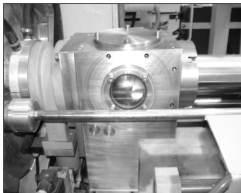
Gambar 3. Gambar *Welding Chamber* yang tersedia
