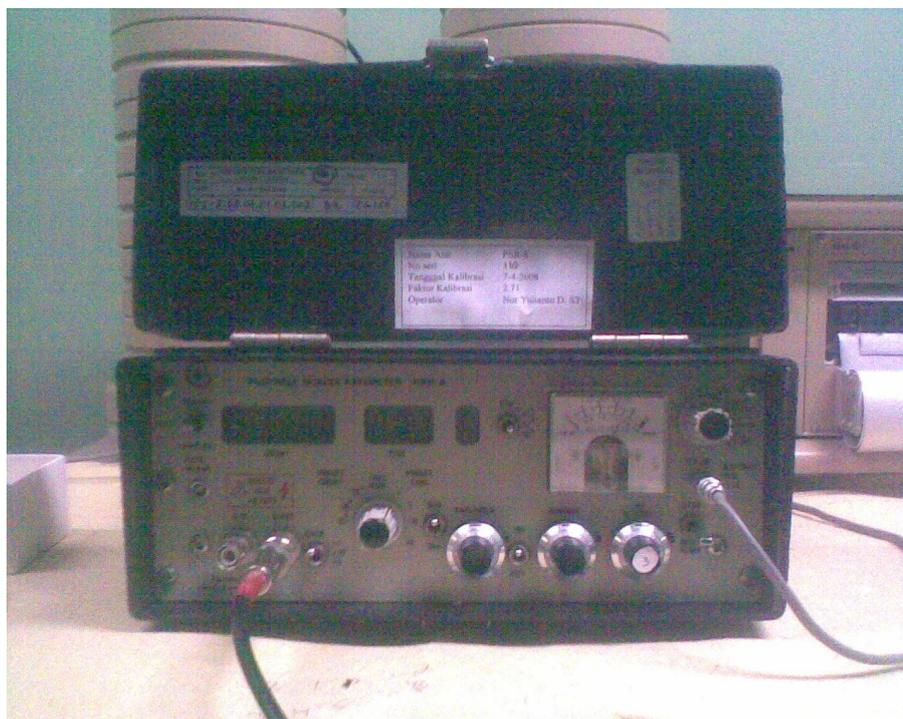
Gambar-1 : Alat Pencacah Radiasi alpha PSR-8
