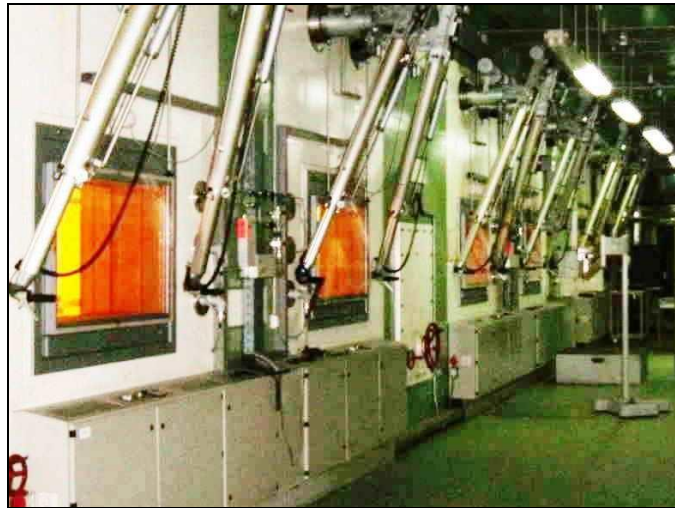
Gambar 6. Hotcell beton tempat bahan radioaktif aktivitas tinggi di IRM.
