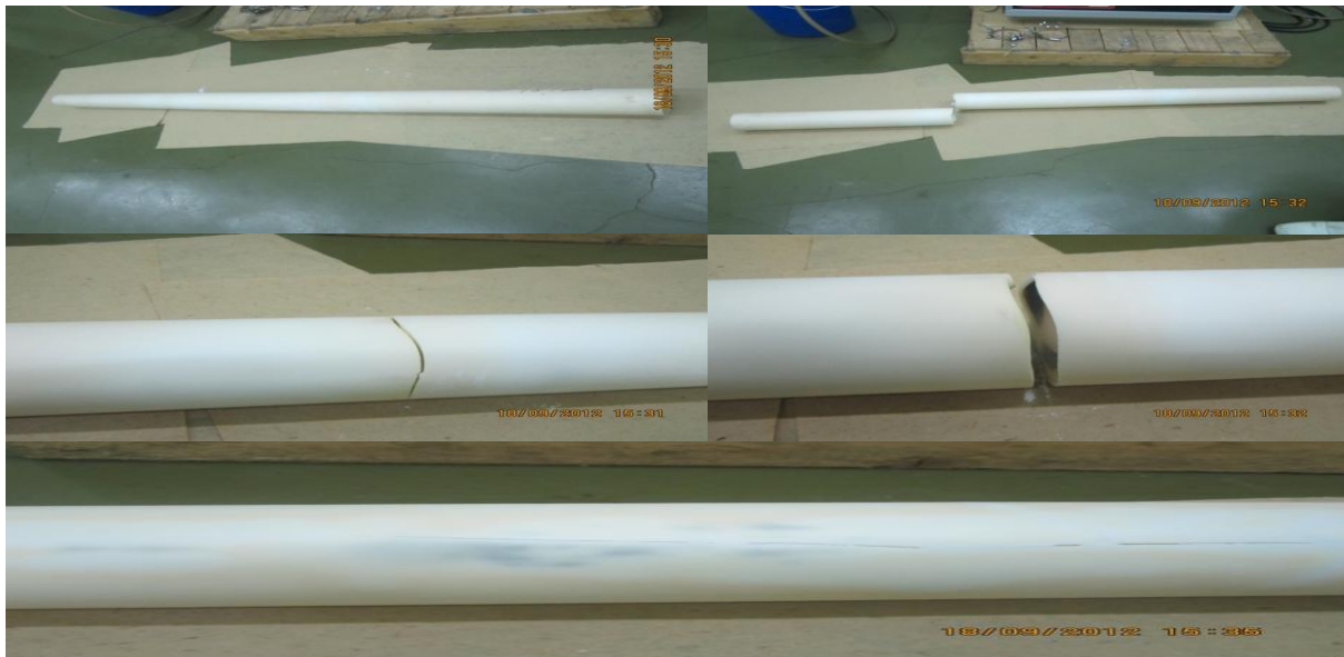
Gambar 8. Keretakan/patah pada tabung alumina.
