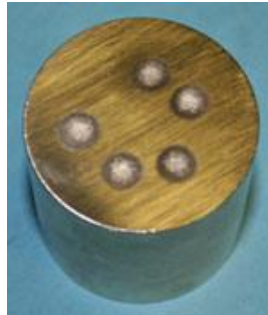
Gambar 2. Tanda sparking pada Permukaan Sampel [2]
