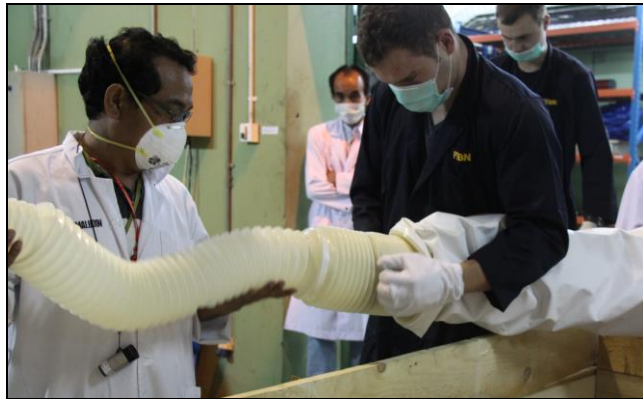
Gambar 3. Pemasangan booting pada slave arm unit
