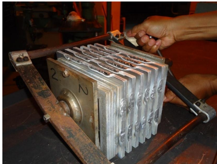
Gambar 3. Hasil pengelasan paket rol PEB U-7Mo/Al
