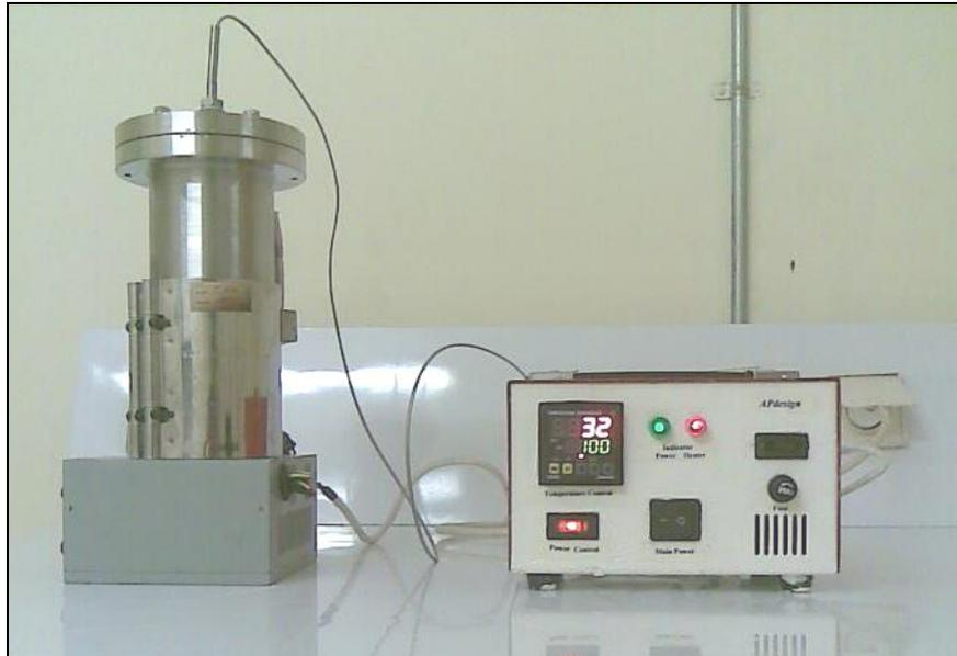
Gambar 4. Uji pengoperasian *autoclave* mini
