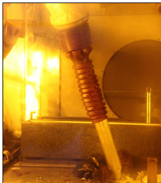
Gambar 4. Terputusnya mekanisme gerakan naik-turun slave arm dan kerusakan booting
