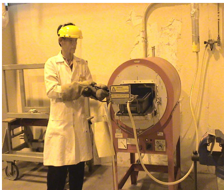
Gambar-3. Tungku pemanas untuk pembuatan foil U
