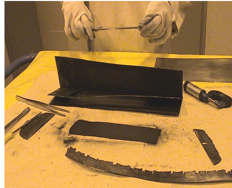
Gambar-7. Foil Uranium hasil rol panas
