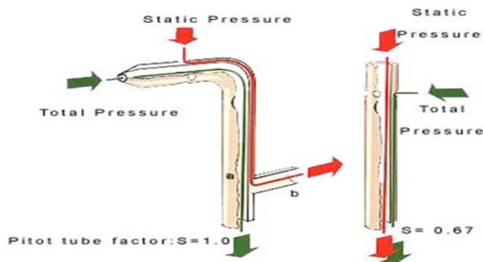
**Gambar 3.** Kecepatan udara diukur dengan menggunakan tabung Pitot
