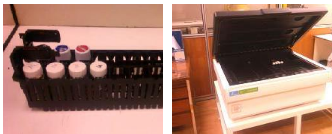
Gambar 3. Vial standar dan sampel dalam rak, serta pencacah LSC TRICARB 2910TR.
