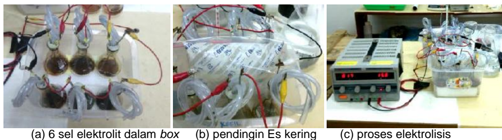
Gambar 2. Rangkaian sel elektrolit dengan suplai tegangan DC HY3030E
