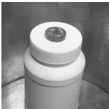
Gambar 1. Pengukuran laju transmisi sumber titik standar di atas wadah sampel.
