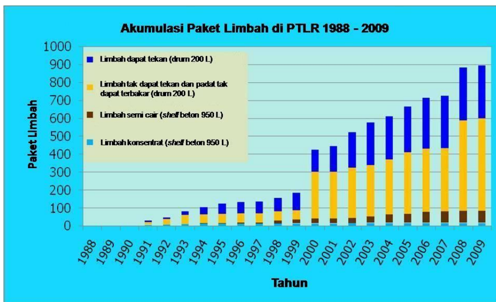
Gambar 1. Akumulasi paket limbah yang berada dalam fasilitas penyimpanan sementara di Serpong.
