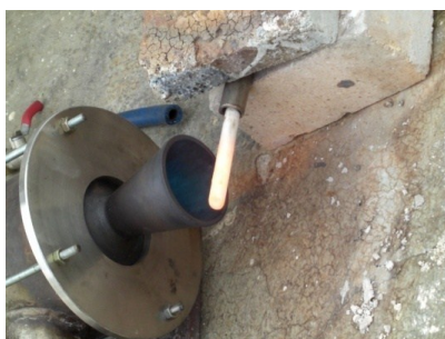
Gambar 13. Simulasi uji panas pada nosel ST37 pasca boronisasi pada suhu 1000 °C selama 8 jam.
