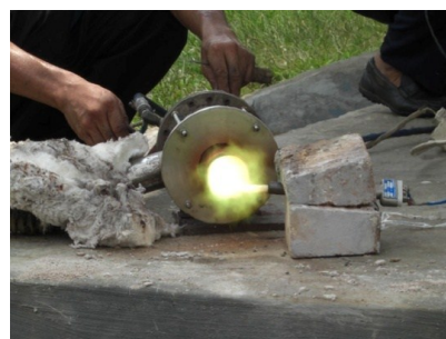
Gambar 13. Simulasi uji panas pada nosel ST37 pasca boronisasi pada suhu 1000 °C selama 8 jam.
