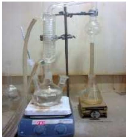
Gambar 1. Proses pelindian dalam pembuatan zirkon *opacifier*.
