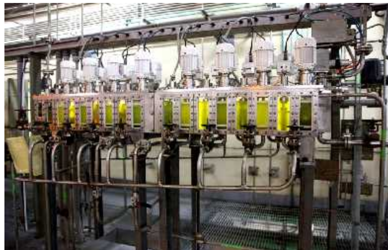
Gambar 1. Rangkaian proses pemurnian uranium menggunakan alat mixer settler [2-3]
