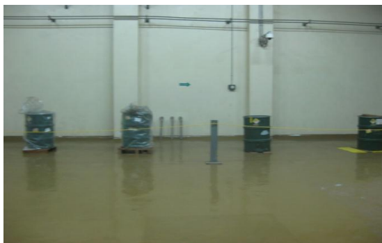
Gambar 3. Foto Penempatan container produk logam U menggunakan jarak-aman.
