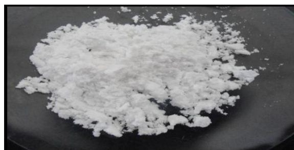
Gambar. 6. Hasil endapan zirkonium-sulfat.
