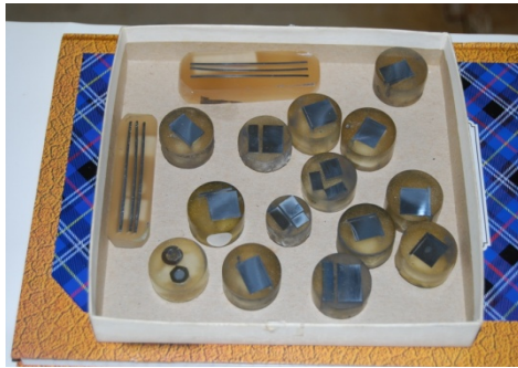
Gambar 2. Sampel metalografi siap dianalisis dengan SEM.
