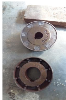
Gambar 5. Kopling pompa pendingin sekunder selatan yang rusak
