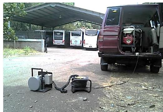
**Gambar 14. Sistem alat pencuplik udara (model staflex sumber arus AC dari generator set)**
