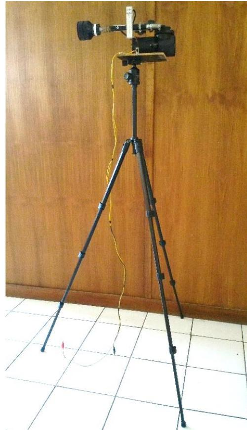
Gambar 13. Sistem pencuplik udara model *portable-adjustable* secara keseluruhan
