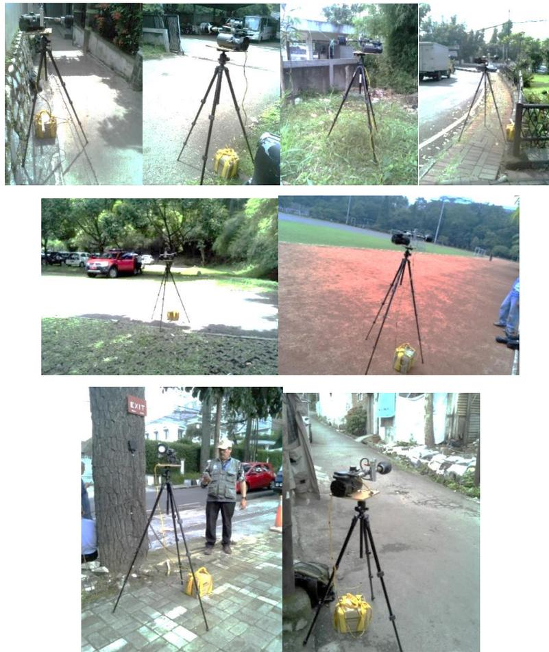
**Gambar 16.** Kegiatan pengambilan cuplikan udara menggunakan sistem pencuplik udara *portable-adjustable* oleh petugas di lokasi titik pengambilan cuplikan (gang, perumahan, halaman, jalan raya, dan lapangan)
