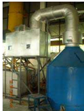
Gambar 1. Prototipe tungku pembakar limbah radioaktif HK-2010.
