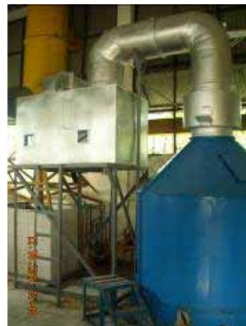
Gambar 1. Prototipe tungku pembakar limbah radioaktif HK-2010.
