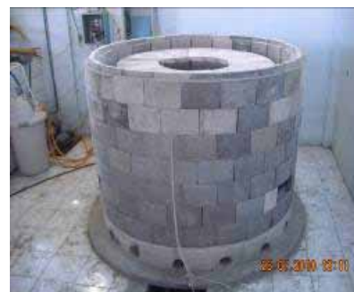
Gambar 4. Pemasangan termokopel di dinding bata primer dan sekunder.
