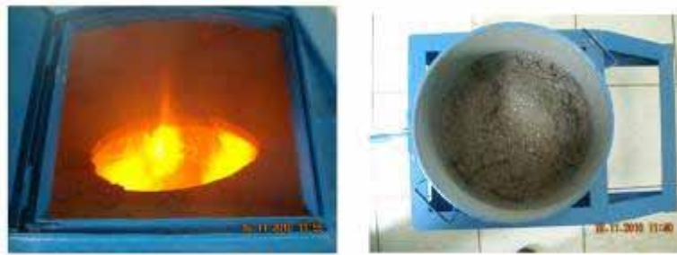
Gambar 13. Ruang bakar saat operasi dan abu hasil pembakaran.
