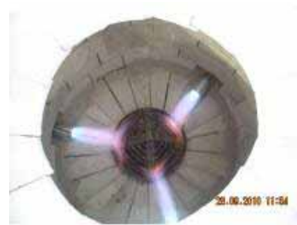
Gambar 6. Kondisi ruang bakar sebelum limbah dimasukkan.
