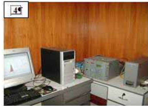
Gambar 4. Sistem TLD-reader yang digunakan untuk membaca TLD (8)
