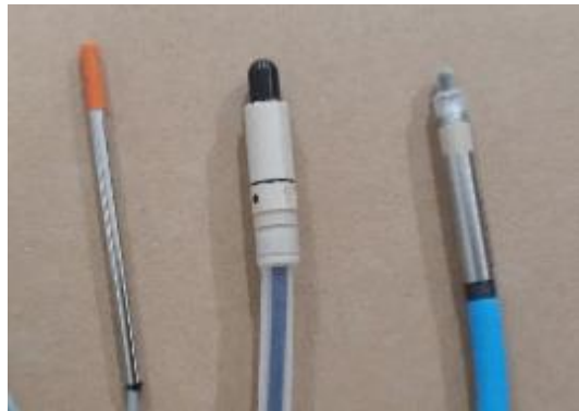
Gambar 2. Detektor IBA Razor, IBA CC13 dan PTW PinPoint 3D
