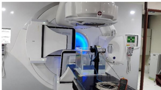
Gambar 1. Pesawat Pemercepat Linier Medik Elekta Versa HD
