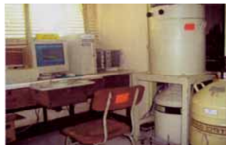
Gambar 1. Spektrometer sinar- \gamma di lab cacah bidang K2 PTNBR-BATAN, Bandung.
