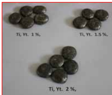
Gambar 3. Ingot logam hasil peleburan dan pemaduan
