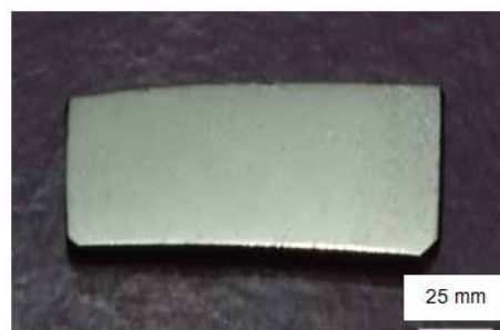
Gambar 4. Proses rol pada bahan ingot dan bentuk pelat yang dihasilkan
