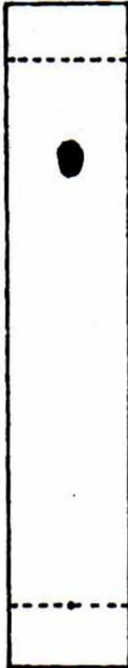
Gambar 3. Hasil analisis kromatografi lapis tipis menaik menggunakan pelat metil selulosa, dan eluen campuran pelarut n-butanol : asam asetat: air dengan perbandingan 4:1:5, serta penampak noda uap iodium memberikan  $R_f = 0,78$
