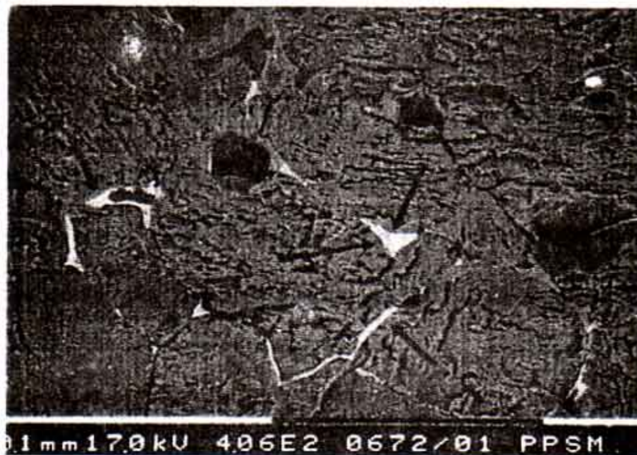
Gambar 8. Struktur mikro sampel ZnO+1%mol Nb 2 O 5 disinter 1400°C/1Jam (Difoto menggunakan SEM mode BSE), memperlihatkan kehadiran fase cair berwarna putih (lihat tanda panah).
