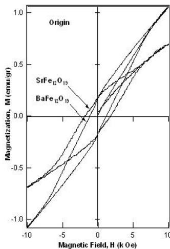
Gambar 2. Kurva histerisis serbuk Ba, $SrFe_{12}O_{19}$  sebelum proses *sintering* (sampel Origin).
