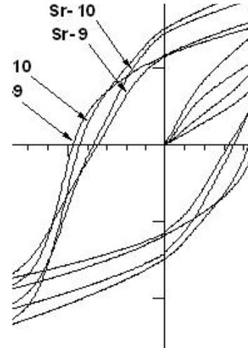
Gambar 3. Kurva histerisis serbuk magnet  $BaFe_{12}O_{19}$  dan  $SrFe_{12}O_{19}$  setelah proses *sintering* pada 900 °C.
