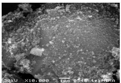
Gambar 4. Foto distribusi morfologi permukaan nanokomposit TiO 2 -PCC dengan SEM
