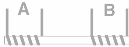
Gambar 2. Bentuk sederhana sensor magnetik fluxgate
