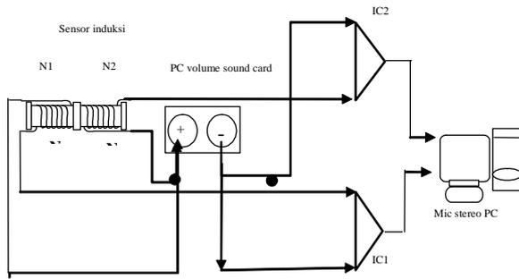
Gambar 4. Diagram blok sistem alat penampil kurva histeresis
