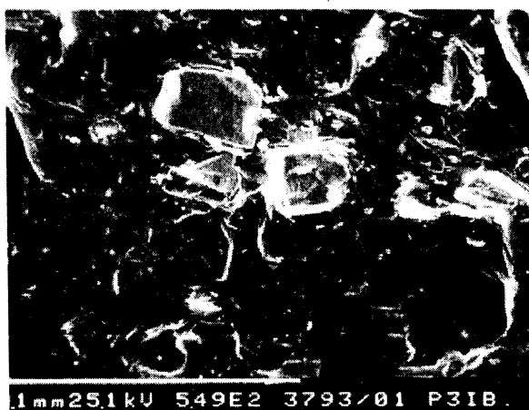
Gambar 6. Foto SEM komposit magnet MQP0 serbuk 20 jam - EVA
